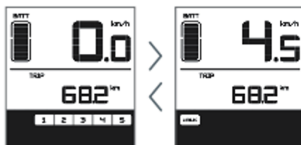
Wechsel zwischen Motor-Unterstützung und Schiebehilfe-Modus
