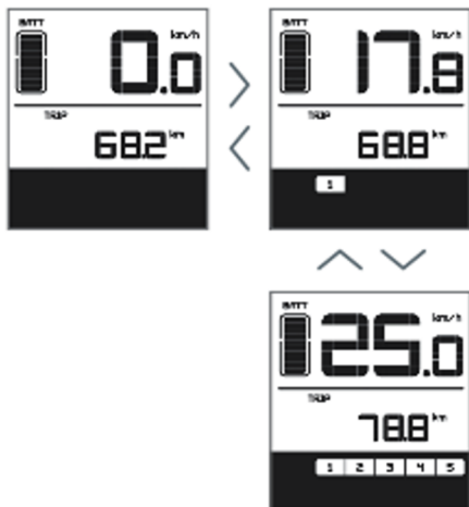
Auswahl der Stufe für die Unterstützung durch den Motor
